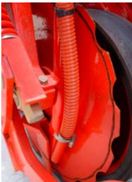
Fig. 21 - Sembradora SD-1203: soldar el suplemento al tubo de descenso de semilla.
