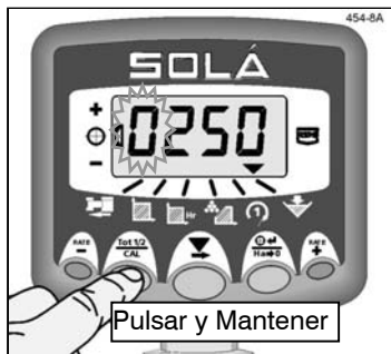
Figura 8a: Vista de la referencia por la activación de la alarma de tolva
