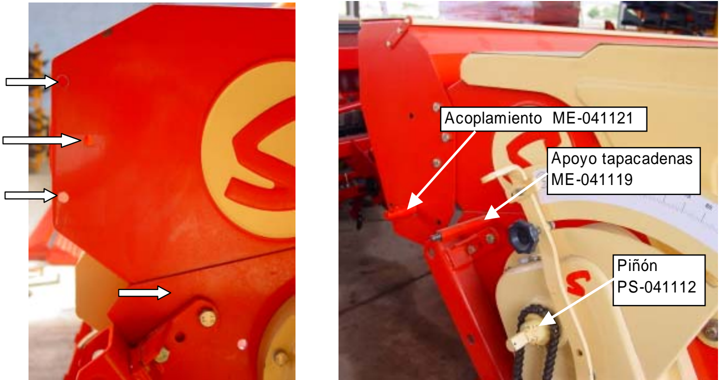
Fig. 10 y 11 - Se taladran los agujeros de Ø11 en los laterales de la tolva de semilla para poder montar la tolva de microgranulados, el acoplamiento largo del variador, el apoyo del tapacadenas y el piñón de salida del variador de la máquina.
