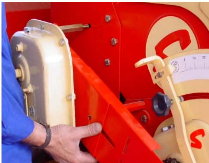
Fig. 12 - Montamos el variador provisto de las prolongaciones ME-041123 en el lateral de la tolva, fijándolo con tuercas autoblocantes y arandelas. Colocamos la cadena comprobando que su longitud sea la correcta.
